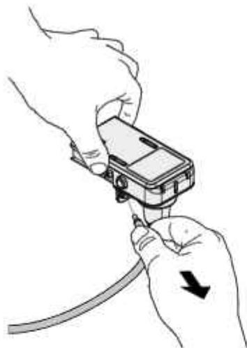
Снять трубку всасывания с отверстия на левой стороне аппарата. Снять защитную резинку с отверстия на левой стороне аппарата и вставить ее в отверстие на правой стороне аппарата.
