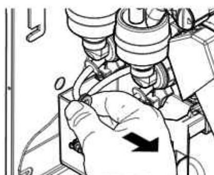
Снять левый штуцер с насадки Cappuccinatore.
