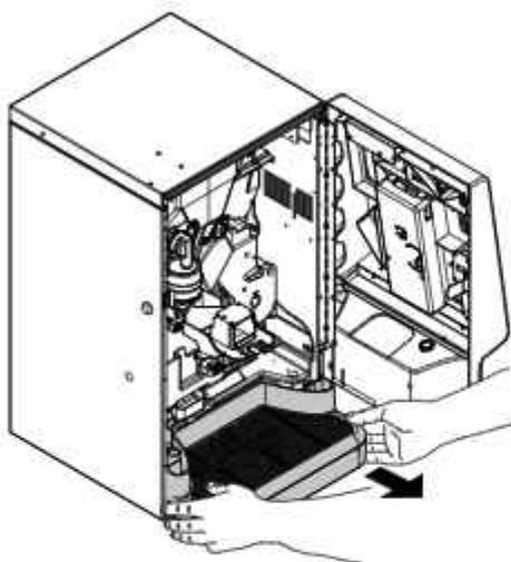
Die Flüssigkeiten im Komplex Abtropfschale ausschütten. Die 3 Sperrn A lösen. Den oberen Bereich des Komplexes Abtropfschale vom unteren Bereich abnehmen. Die beiden soeben demontierten Teile sorgfältig reinigen.
