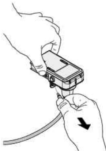
Ansaugschlauch aus dem Loch auf der linken Seite des Automaten herausziehen. Den schützenden Gummistöpsel vom Loch auf der linken Seite des Automaten entfernen und in das Loch rechts auf dem Automaten einstecken.
