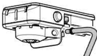
Ansaugschlauch in das Loch auf der rechten Seite des Automaten einführen. Cappuccinatore wieder an seinem Sitz setzen. Die Tür schließen.
