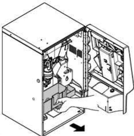
Die Kaffeesatzschale wieder einsetzen. Den Ausgabeblock wieder einbauen. Den Komplex Abtropfschale wieder einbauen. Den Kaffeesatzbehälter und den Komplex Abtropfschale, die zuvor ausgebaut wurden, wieder einsetzen.
