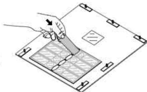
Prüfen, ob die Schilder den Auswahltasten entsprechend richtig angeordnet sind. Die Tastatur-Platte wieder einsetzen. Mit einem Steckschlüssel die 7 Sperrschrauben der Tastatur-Platte bis zum Anschlag anschrauben.
