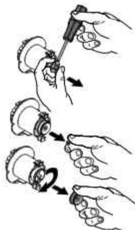
Alle Bestandteile mit lauwarmem Wasser waschen. Mit dem Rad dabei behutsam umgehen, um es nicht zu beschädigen. Für die Montage der Bestandteile die Vorgänge in umgekehrter Reihenfolge ausführen und das Auslaufrohr ordnungsgemäß anschließen.
