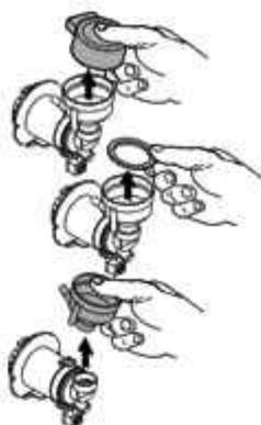
Den Feststerring im Uhrzeigersinn drehen und den Mischerkörper herausziehen.
