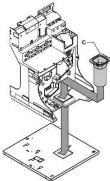
Soll das Gerät auf einer Arbeitsfläche aufgestellt werden, muss für den Auswurf des Kaffeesatzes in einen Behälter unter der Fläche eine Bohrung F mit einem  $\varnothing$  von 75 mm (mind.) in der Arbeitsfläche ausgeführt werden, wie in der Abbildung gezeigt. Die Maschine endgültig auf der Abstellfläche positionieren (die Kreise P geben die optimale Position der einstellbaren Füße an).
