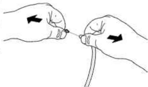
Das Innere des Milchsaugschlauchs mit dem Schaber reinigen, wie in der Abbildung gezeigt.
