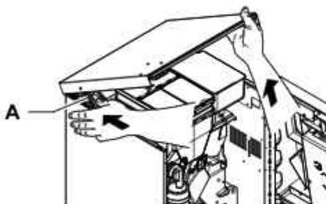
Um die Tür zu blockieren, muss die Tür leicht angehoben, der Bügel A gezogen und dann die Tür abgesenkt werden.
