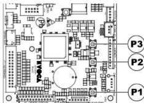
Wird die Taste während des Aufheizvorgangs am Anfang gedrückt, wird "MASCHINE BEREIT" hinausgezogen, ohne dass die Durchlauferhitzer die programmierten Temperaturen erreichen.
