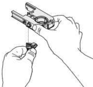
Die Teile unter laufendem Wasser reinigen. Sicherstellen, dass eventuelle Ablagerungen/Verkrustungen der Milch entfernt wurden. Die Teile des Cappuccinatore in umgekehrter Reihenfolge wieder zusammenbauen, dabei sicherstellen, dass der Schlauch nicht abgeknickt und in den entsprechenden Durchgängen verlegt wird.
