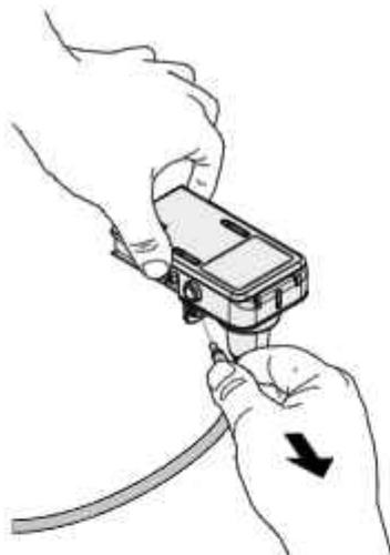
Dra ut Insugningsröret från hålet på automatens vänstra sida. Ta bort tätningringen från hålet på automatens vänstra sida och sätt in den i hålet på automatens högra sida.
