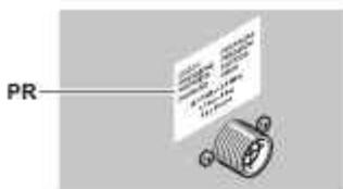
PR Datenschild Höchstdruck Wasserversorgung
