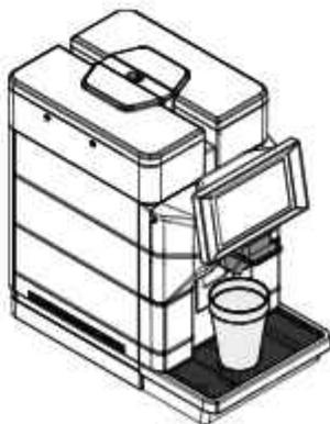
Auf das Symbol „Hot Water“ tippen, um die Ausgabe von HEISSEM WASSER zu starten. Nach Abschluss der Ausgabe des heißen Wassers den Behälter leeren. Die Maschine ist betriebsbereit.
