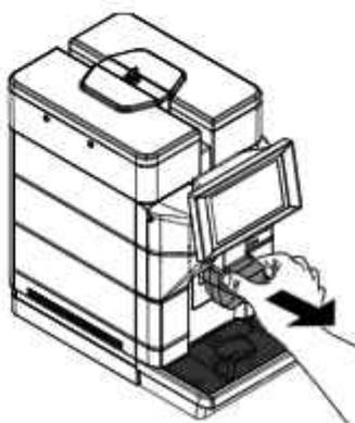
Entfernen Sie die beiden Dosierdüsen wie abgebildet.
