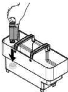
Den Tank mit frischem Trinkwasser füllen und wieder in die Maschine einsetzen. Einen Behälter unter die Heißwasserdüse stellen.
