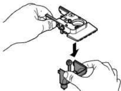
Entfernen Sie alle Teile der unteren Abdeckung des Cappuccinatore wie in der Abbildung gezeigt.
