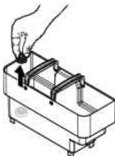
Den Wasserfilter in den leeren Tank einsetzen. Bis zum Einrasten drücken.
