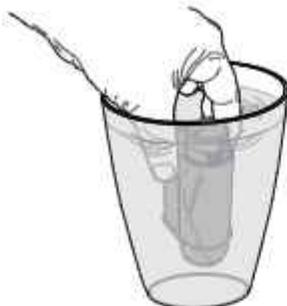
Den Tank aus der Maschine herausnehmen und leeren. Den kleinen weißen Filter aus dem Tank herausnehmen, an einem trockenen Ort aufbewahren und vor Staub schützen.
