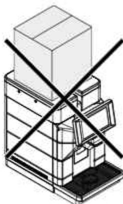
⚠ Aufgrund des Gesamtgewichts ist die Stapelung von mehr als drei Maschinen verboten. Die Maschine muss in der Originalverpackung trocken und/oder vor Staub geschützt eingelagert werden.
