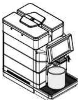
Die Maschine führt Waschzyklen der Kaffeegruppe mit einer Entfettungstablette durch. Warten Sie, bis die Zyklen automatisch beendet werden. Daraufhin wird folgende Ansicht angezeigt:
