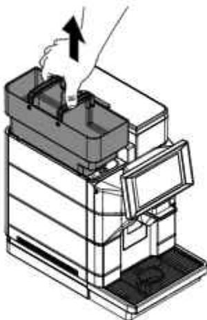
Ausspülen und mit frischem Wasser füllen; der im Tank angegebene maximale Füllstand (MAX) darf nicht überschritten werden.
