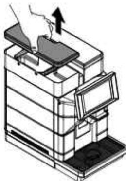
Setzen Sie den Deckel auf den Wassertank wieder auf. (Nur wenn das Gerät an das Wassernetz angeschlossen und darauf eingestellt ist). In den Wassertank 250 ml Entkalkungsmittel füllen.
