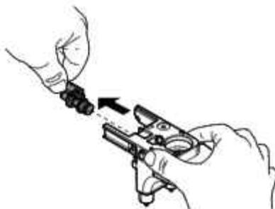
Entfernen Sie die untere Abdeckung des Cappuccinatore.
