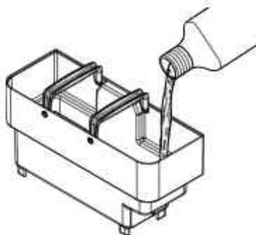
Wasser bis zum Füllstand „CALC CLEAN“ in den Wassertank einfüllen.
