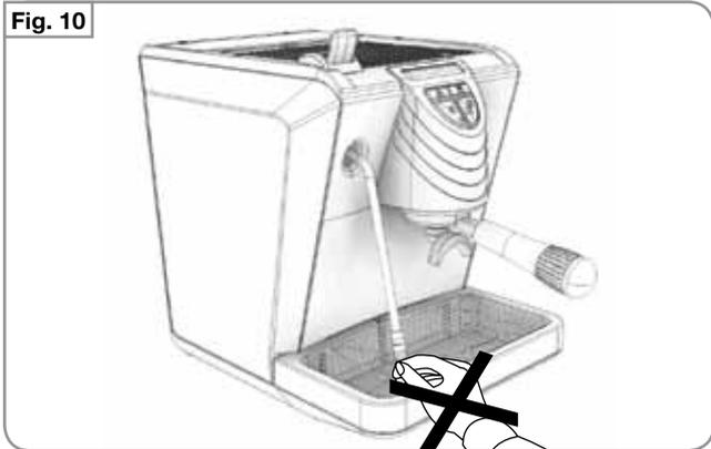
Pour favoriser l'aération de la machine la placer à 15 cm de murs ou d'autres machines du côté de l'aération.
