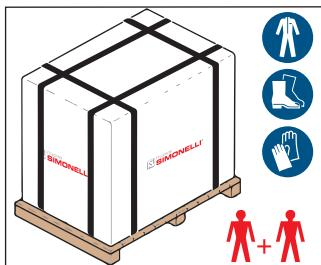
Der Transport der Maschine erfolgt zusammen mit anderen Maschinen auf einer Palette in großen Schachteln, die mit Umreifungen an der Palette befestigt sind.
