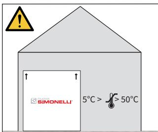
Die Box mit der Maschine muss wetterunabhängig gelagert werden.
