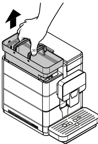
Измийте резервоара и го напълнете с прясна вода; не надхвърляйте максимално допустимото ниво (MAX), указано в резервоара.
