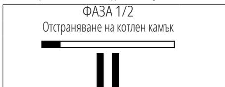
Започва първата фаза на отстраняване на котлен камък. За да поставите операцията в режим на пауза, натиснете бутона „OK“. За да задействате отново операцията, натиснете повторно бутона „OK“. Когато разтворът в резервоара свърши, кафемашината ще изиска изпразване и измиване на резервоара с прясна питейна вода.
