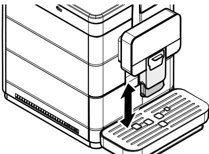
Для выполнения регулировки приподнимите или опустите вручную устройство подачи.
