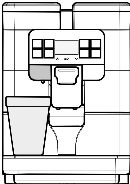
Нажмите кнопку подачи «Hot Water», через несколько секунд из устройства подачи горячей воды начнет выходить горячая вода. На дисплее появится:
