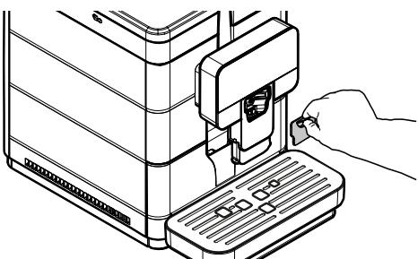
Вставьте насадку Cappuccinatore до упора в гнездо. Проверьте, чтобы она не снималась.
