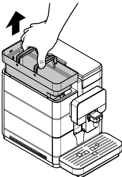
Помойте с неабразивным моющим средством, прополосните свежей водой и тщательно высушите.
