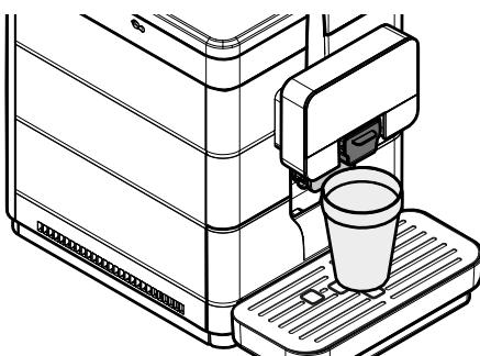
Нажмите кнопку «Coffee», чтобы начать подачу. Машина выполнит подачу кофе из устройства подачи; дождитесь завершения подачи и опорожните емкость. Повторите такие подачи 3 раза.
