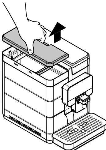
Ополосните и наполните бак свежей водой; не превышайте максимальный уровень (MAX), указанный на баке.
