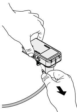
Снимите хромированный кожух с Cappuccinatore. Извлеките клапан из Cappuccinatore.
