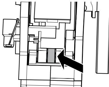
Установите заново блок приготовления кофе в специальное отделение до достижения соединения БЕЗ нажатия на кнопку «PRESS». Закройте дверцу для обслуживания.
