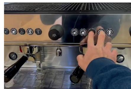
**3.** El lavado se debe hacer **independientemente en cada grupo de la maquina**. Para ello se debe repetir la operación del portafiltro y el detergente además de presionar la combinación de teclas del continuo y dos cafés cortos.
