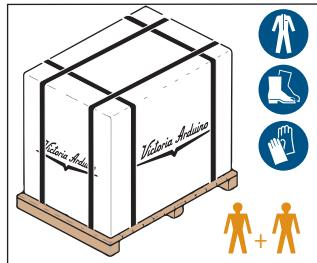
La machine est transportée sur des palettes avec d'autres machines et à l'intérieur de cartons fixés aux palettes au moyen des courroies appropriées.
