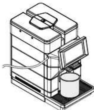
La máquina realiza un ciclo de lavado del capuchinador con detergente. Esperar a que el ciclo termine de forma automática. Aparecerá la siguiente pantalla:
