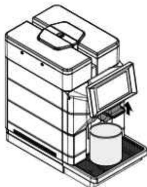
Realizar la primera fase de descalcificación. Cuando ya no quede solución en el depósito, la máquina solicita que se vacíe y se enjuague el depósito con agua potable fresca. Enjuagar bien el depósito.
