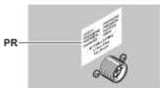
PR Placa de datos de presión máxima de alimentación del agua
