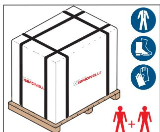
La macchina viene trasportata in pallet con più macchine dentro scatoloni assicurati al pallet con delle centine.
